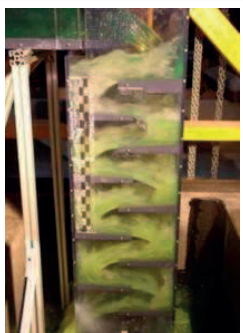
FRANCE | Modèle des Bâteliers - 1/15 ème Écoulement dans le puits de chute
