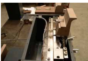
ITALIE | Mesure des efforts hydrodynamiques sur un mur de couronnement
