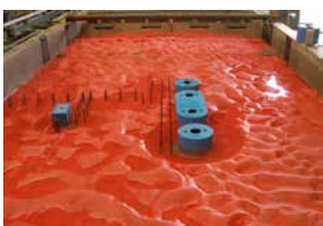
ITALIE | Mesure des efforts hydrodynamiques sur un mur de couronnement
