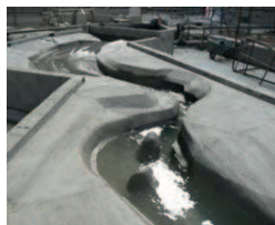
Brésil | Modèle sédimentologique de Jirau 1/1000 ème en plan et 1/100 ème en vertical
