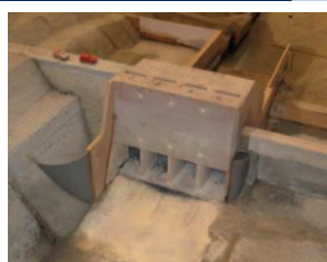
OMAN | New Fulaj-Dam Wadi Rafsa 1/50 ème Vannes de fond
