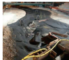
Brésil | Modèle sédimentologique de Jirau 1/1000 ème en plan et 1/100 ème en vertical
